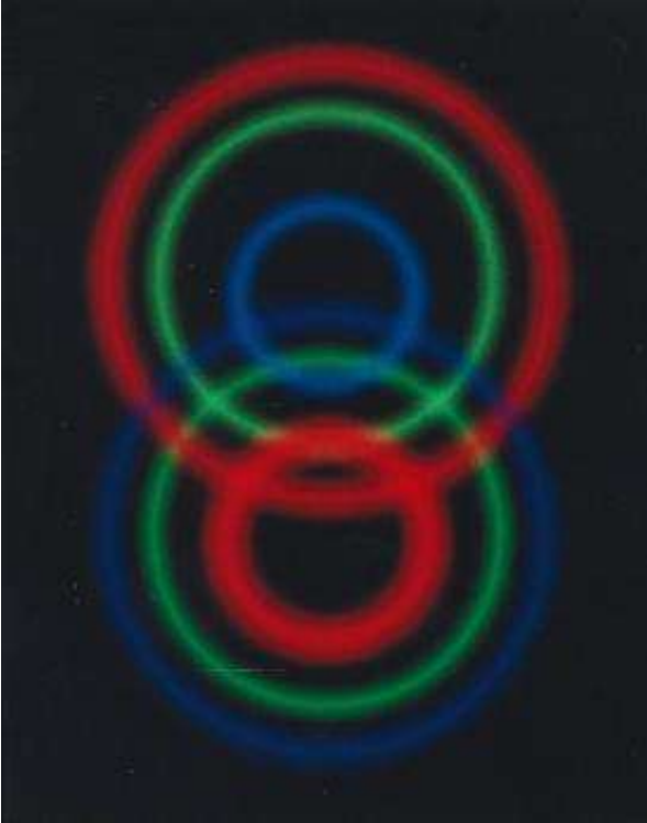
Figura 1: Conservación de energía por PDC. Anton Zeilinger [11] y Y.S. Lee [12] ha demostrado que el láser ultravioleta incide en un cristal no lineal a través del proceso de PDC para reducir los fotones de energía. Por lo tanto, permite que cada fotón se divida en dos longitudes de onda más largas. La energía de los fotones individuales se convirtió en una proporción inversa de su longitud de onda inicial, aumentando la expansión cuántica asociada en una densidad decreciente 16 veces y aumentando el volumen espacial asociado.
